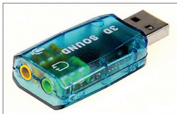
➤ Микрофон с аудиоразъемом можно заставить работать с Pi через небольшую звуковую карту USB.
